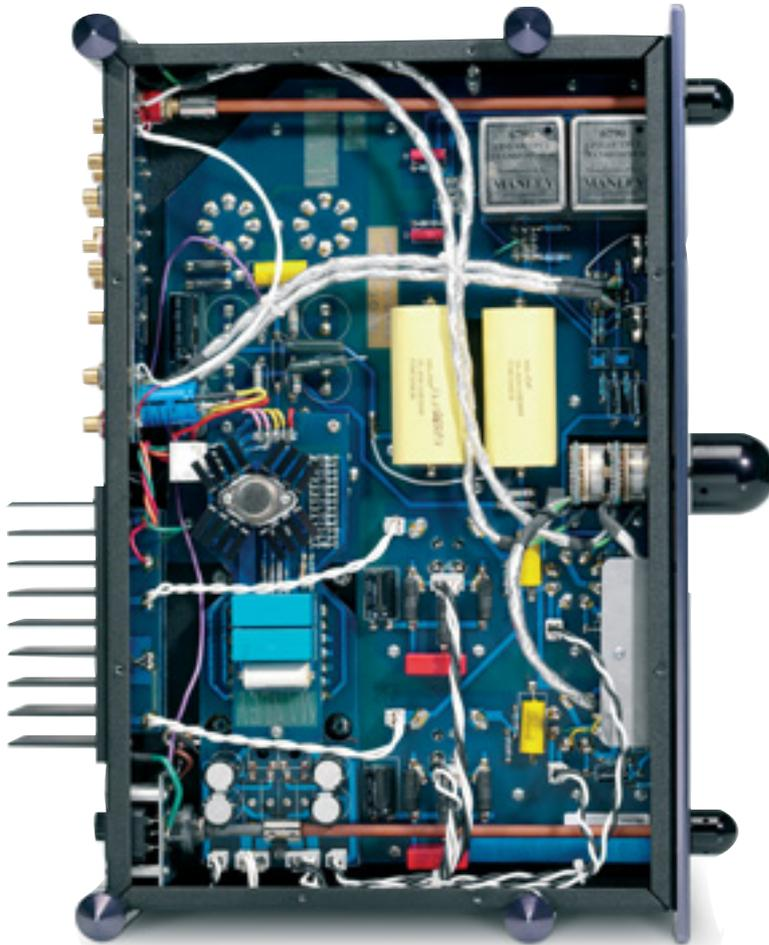
Im Vorverstärker dominieren die beiden mächtigen Koppelkondensatoren. Man beachte den Pegelregler, einen widerstandsbestückten Stufenschalter
