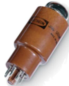
NOS-Stabilisatorröhre OD3. Früher wurde sie in Massen produziert
